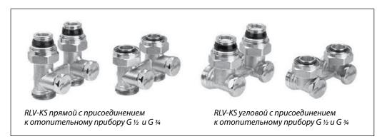
Клапан запорно-присоединительный RLV-KS предназначен для подключения к трубопроводам двухтрубных горизонтальных систем отопления отопительных приборов с нижними присоединительными штуцерами при их межосевом расстоянии 50 мм. Клапан RLV-KS не подходит для присоединения к нему спускного крана.
